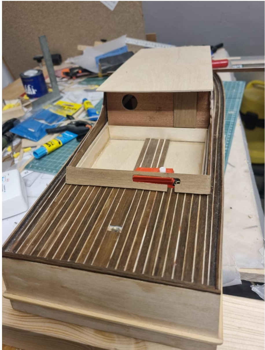
Foto 94: Die eingesetzte Plicht
