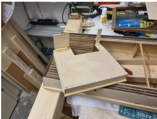
Foto 92: Jetzt wird nach Bauplan die herausnehmbare Plicht aus 1,5 mm Sperrholz angefertigt
