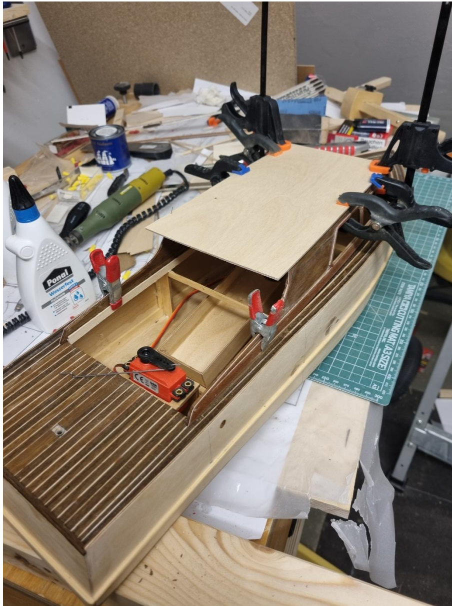
Foto 96: Das Kajütendach wird aufgeleimt
