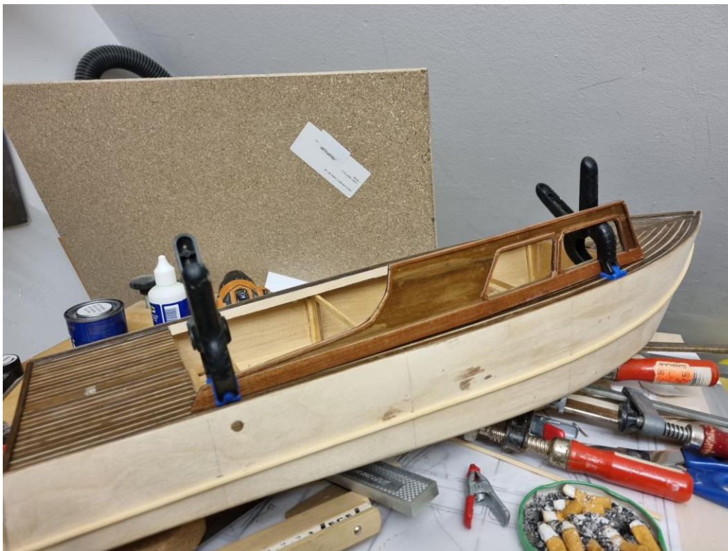
Foto 86: Passprobe der fertigen Kabinenwand an Steuerbord. Man sieht die Profilierungen aus Mahagoni und Nussbaumleisten. Die Fenster erhalten später „Scheiben“ aus glasklaren Polystyrolplatten.
