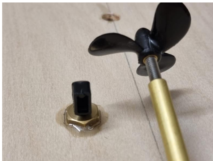
Foto 62: ....Staurohr (Wassereinlass in Fahrtrichtung) nach dem Einbau und Verkleben mit 2-Komponenten-Kleber
