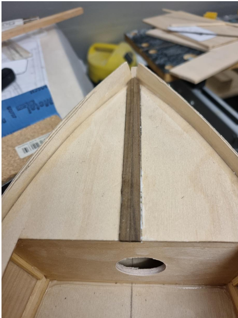
Foto 75: Verlegung der „Königsplanke“ am Bug, achtern wird analog verfahren!
