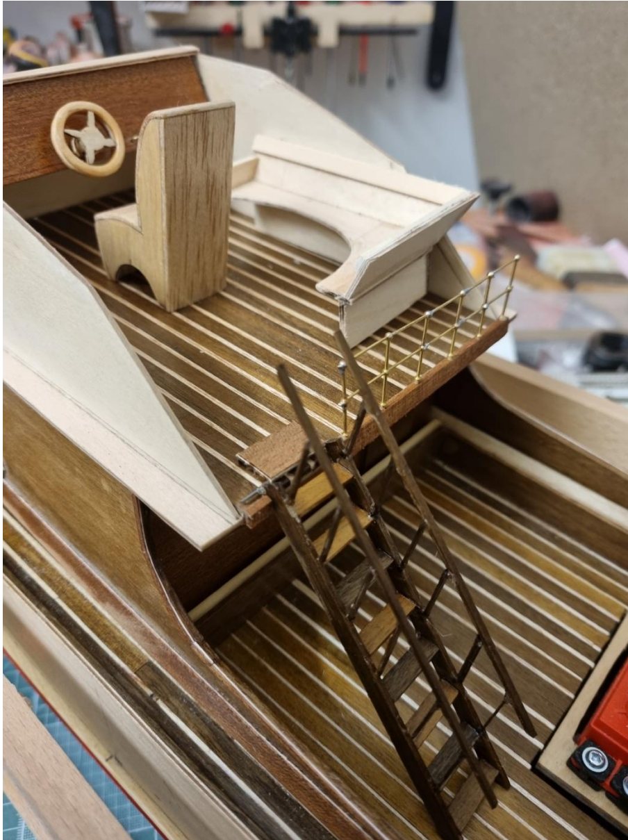
Foto 102: Die Leiter benötigt natürlich ein Geländer, das ebenfalls aus dünnen Nussbaumleisten besteht. Das Verleimen ist etwas fummelig. Unter Die Leiter habe ich oben einen dünnen Stahldraht verklebt. Dieser wird unter den oben sichtbaren Tritt geschoben, wo es dank eine kleinen Nut einrasten kann. Unten ist die Leiter nicht mit dem Deck verklebt. Somit...
