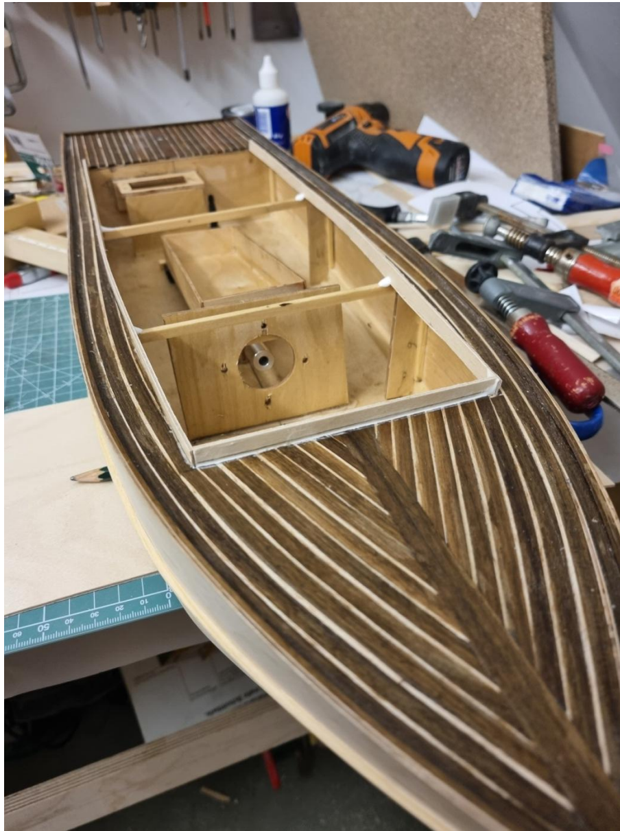
Foto 80: Die fertige Decksbeplankung.
