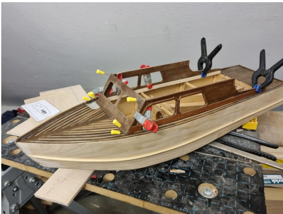
Foto 89: Verleimung der Kajüte. Auf dem Deck Folie unterlegen!
