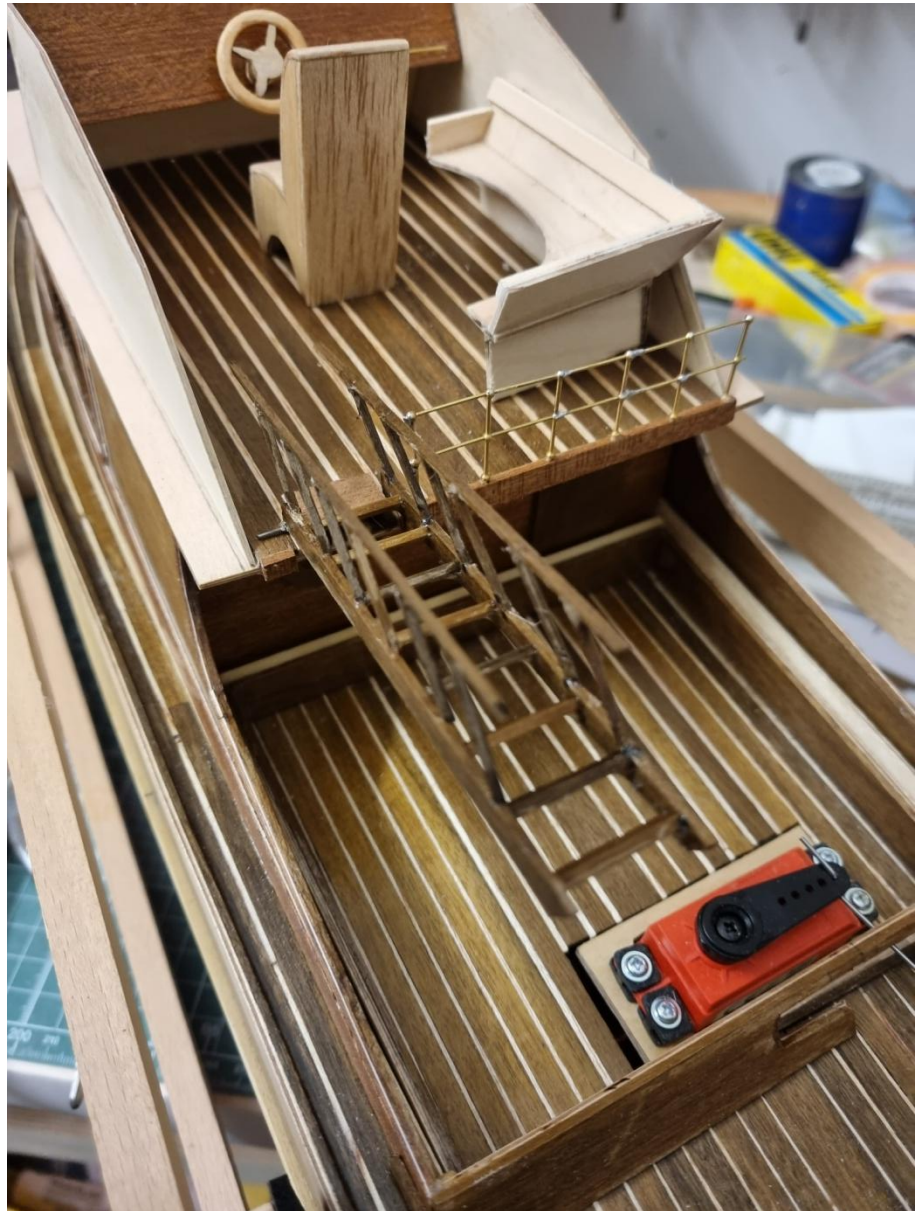
Foto 103: ...kann man sie bei Bedarf hochklappen, was das Abnehmen der Kajüte und der Plicht erleichtert bzw. möglich macht. Wie man sieht sind auch ein Fahrersessel sowie eine Sitzbank als Möblierung in Arbeit! Damit niemand herunterfallen kann, gibt es eine Reling aus Messingdraht und Fertigstützen aus dem Zubehörhandel. Die Reling ist verlötet.
