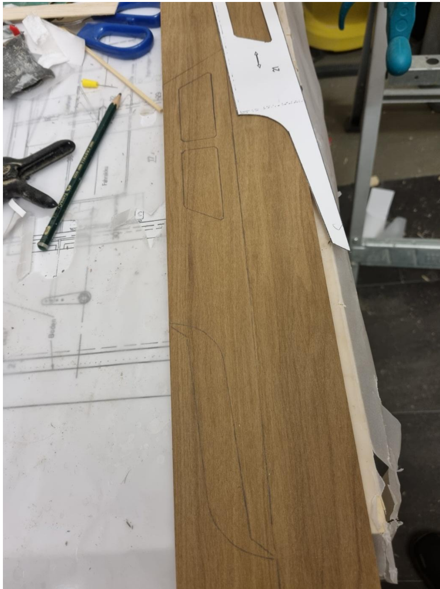
Foto 84: Aufzeichnen der Kabinen-Seitenteile
