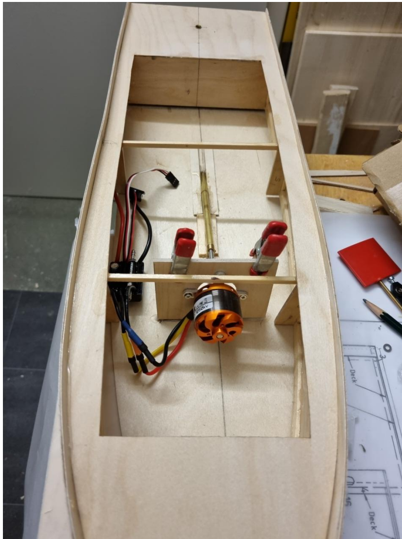
Foto 56: Anprobe des Motors (bereits am Motorträger verschraubt) und des Stevenrohrs mit Schraubenwelle
