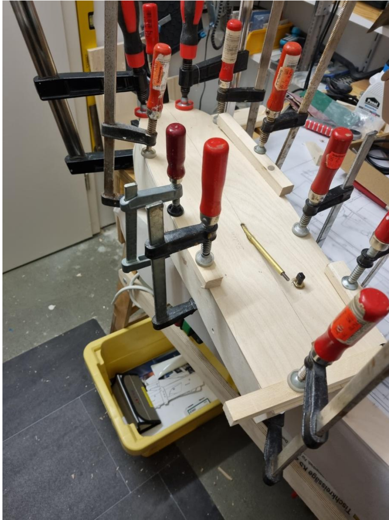
Foto 53 a: Verkleben des Rumpfbodens, in dem ich vorher bereits die Schraubenwelle, genau an der Mittellinie ausgerichtet, provisorisch eingesetzt hatte
