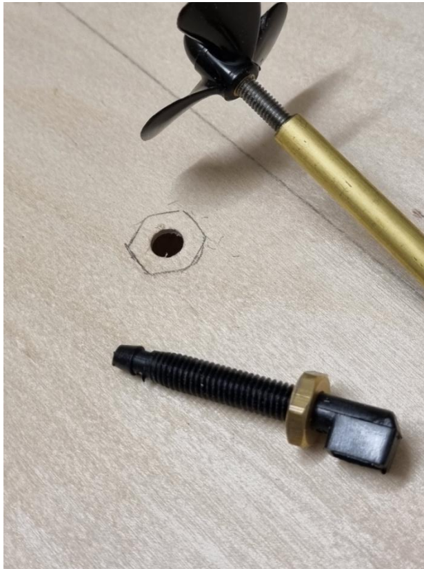
Foto 61: Stevenrohr mit Schraubenwelle und aufgesteckter Schiffsschraube (recht drehend, Fertigteil). Daneben die Bohrung für das Staurohr (Fertigteil)
