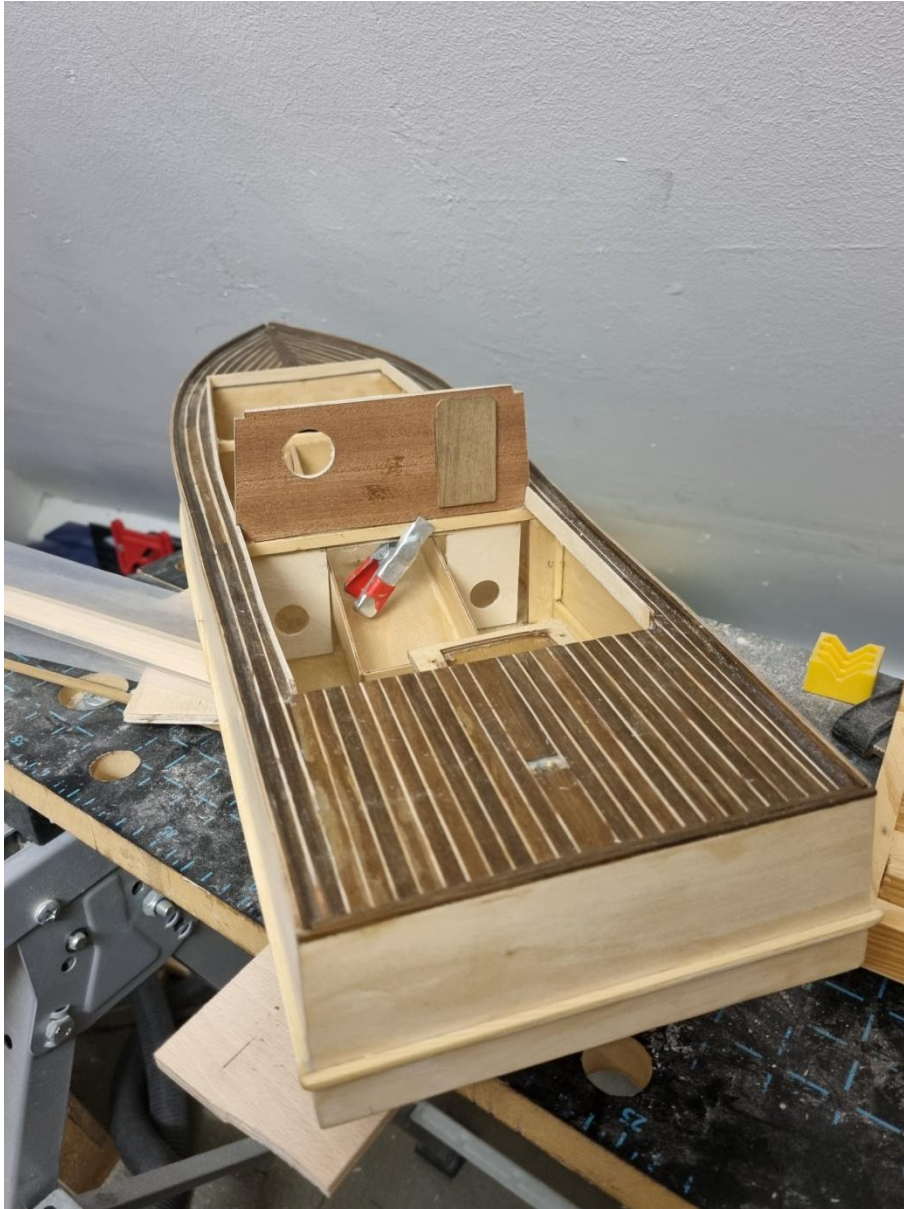
Foto 95: Die eingesetzte Kajütenrückwand. Von innen erhält das Bullauge später eine Verglasung aus einer transparenten Polystyrol-Platte
