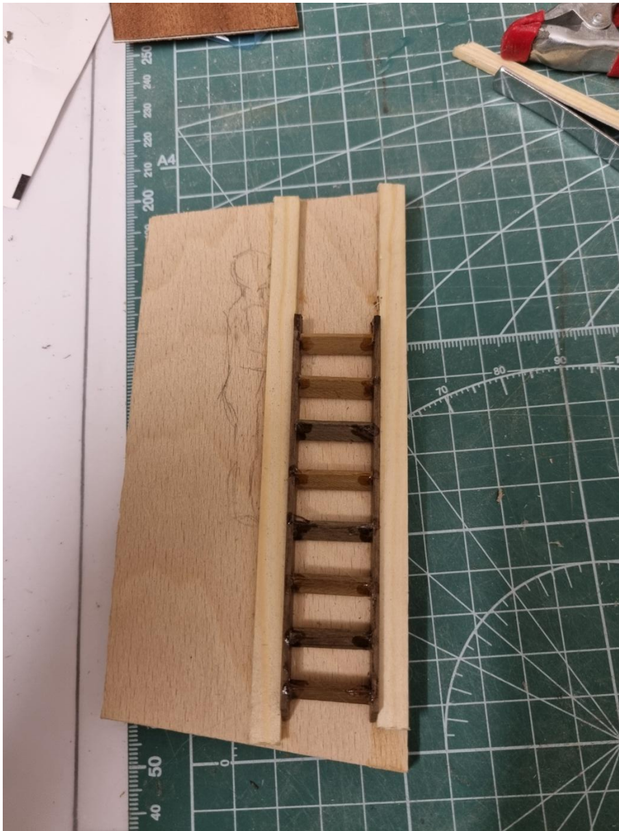
Foto 101: Damit der Skipper auf seine Brücke gelangen kann, benötigt Er einen Auf-bzw. Niedergang. Diesen habe ich aus Nussbaum als simple Holzstreppe gefertigt. Zum Verleimen der Wangen mit den Stufen dient das gezeigte einfache Konstrukt aus Sperrholz und Kiefernleisten. Darauf achten, dass die Leiter daran nicht festklebt!
