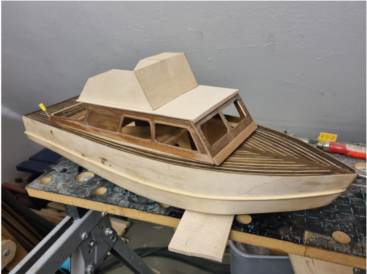
Foto 98: Der Rohbau mit dem provisorisch aufgesetzten Fahrdeck. Die Kajüte ist noch unvollständig und muss noch intensiv verschliffen werden
