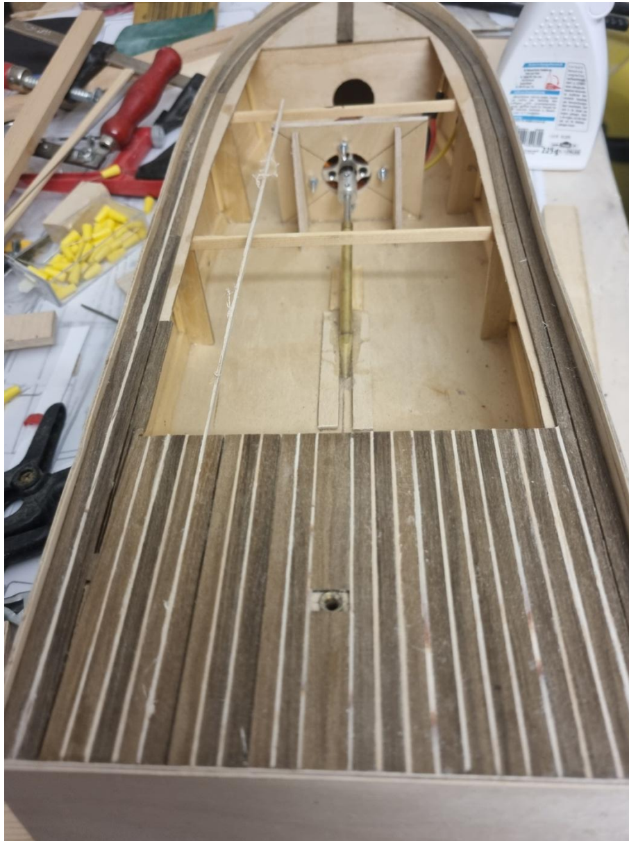
Foto 78: Das Foto zeigt die Verlegung der Planken zum Bug hin. Die „Kalfaterung“ in Form dünner Balsaholzstreifen ist bereits teilweise eingefügt
