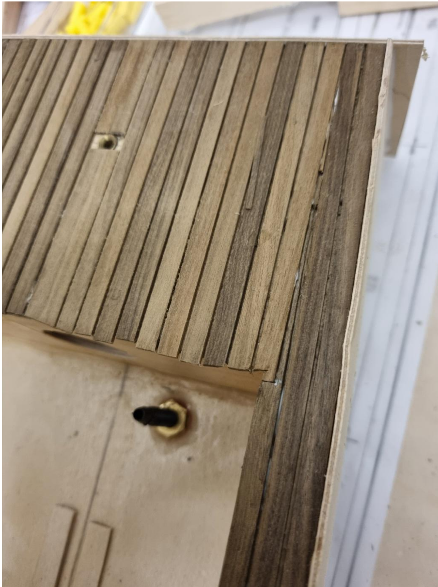
Foto 77: Verlegung der Decksplanken bis zum Bug. Die Leisten für die Planken werden genau eingepasst, damit gleichmäßige Abstände zwischen den Planken für die Kalfaterung entstehen!
