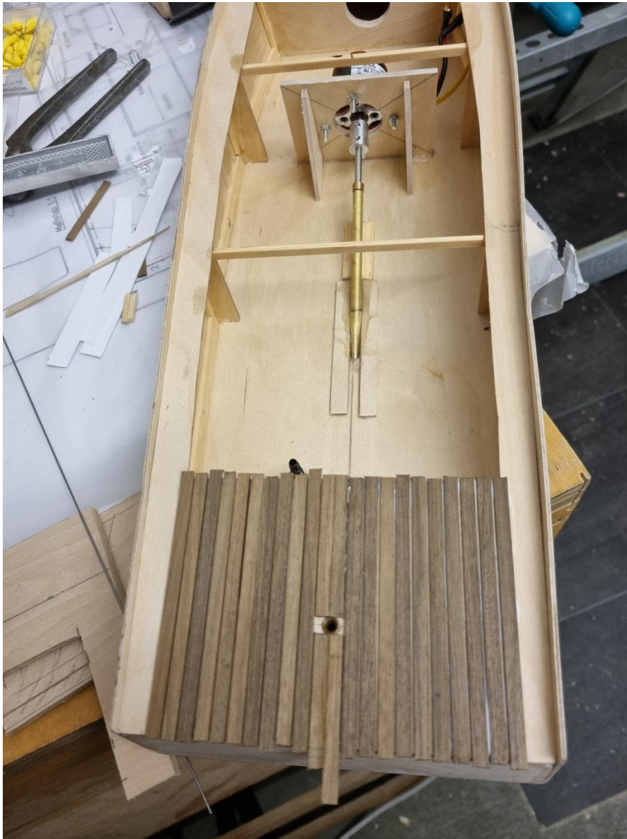
Foto 76: Verlegung der Planken im Heckbereich. In der Mitte die Königs-Planke mit einer Aussparung für die Durchführung der Ruderwelle. Zwischen Allen Planken befinden sich ca. 1 mm Spalten. Hier kleben wir später Dünne Streifen aus Balsaholz ein, welche eine helle Kalfaterung darstellen! (Kalfaterung = Abdichtung zwischen den einzelnen Plankengängen). Die Decks-Planken werden natürlich später oben und unten bündig verschliffen!
