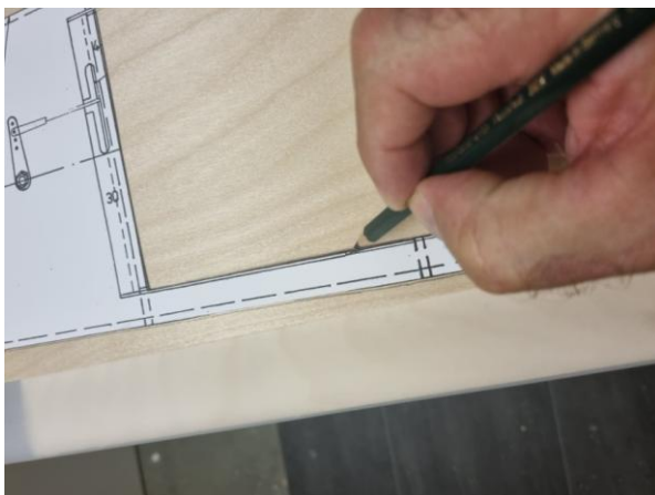
Foto 15: Anzeichnen des Decks u. des Decksausschnitts auf das Sperrholz
