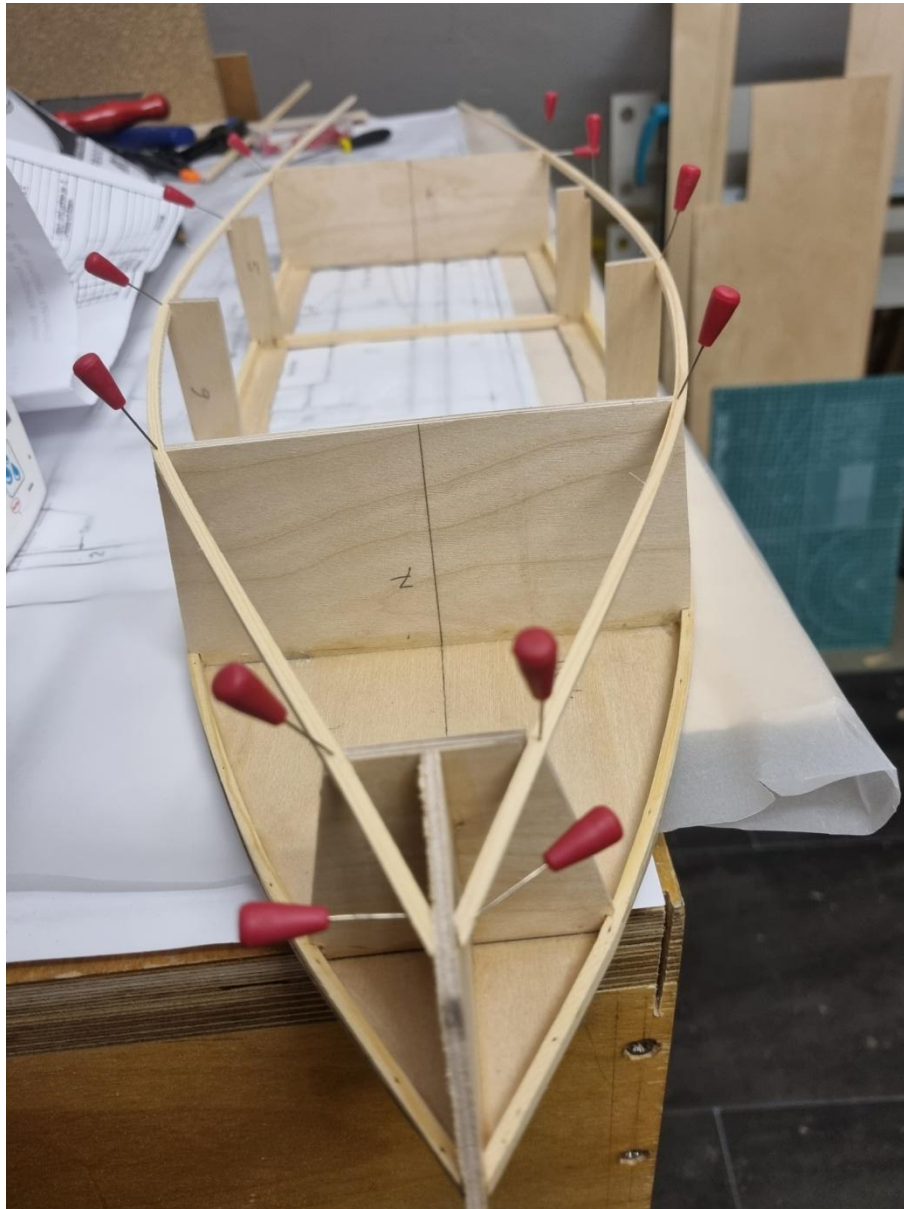
Foto 24: Deckstringer und Kimmstringer bestehen aus dünnen Kiefernholzleisten (3x5 bzw. 3x3 mm)
