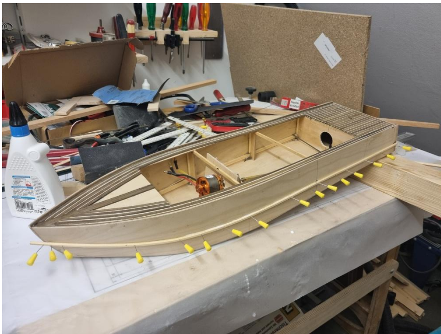
Foto 83: Die Spritzwasserabweiser bestehen aus 3x3 mm Kiefernholzleisten
