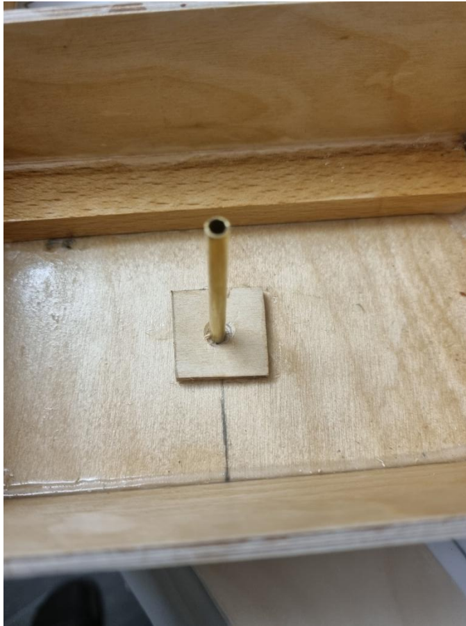
Foto 54: Verstärkung aus Buchenholz (oben) und Durchführung des Führungsröhrchens für die Ruderpinne incl. Verstärkung aus einem quadratischen Stück Sperrholz
