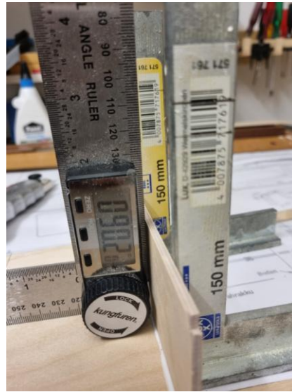
Foto 22: Winkelkontrolle mit digitalem Winkelmesser + Schlosserwinkel
