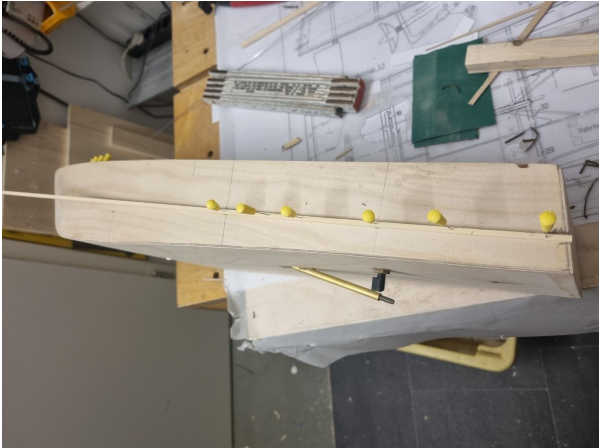
Foto 82 und 83: Anbringen der Spritzwasserabweiser
