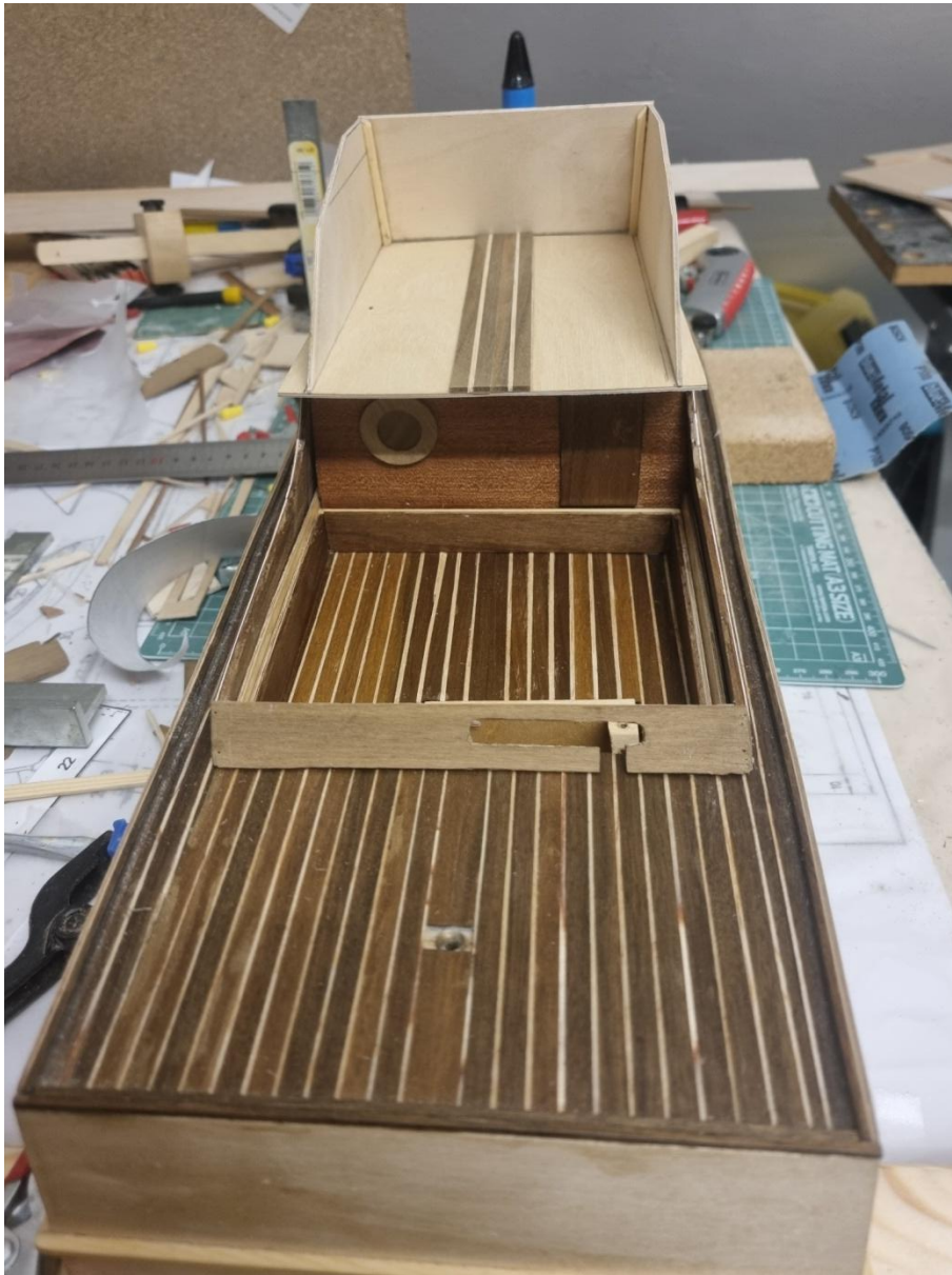
Foto 97: So sollte das Ganze am Ende aussehen. Für das Bullauge habe ich noch einen Ring aus Nussbaumholz gefertigt, der von außen aufgeleimt einen Rahmen um das Bullauge imitiert. Diese Modifikationen habe ich abweichend vom Bauplan vorgenommen! Auf dem Foto ist bereits das im Aufbau befindliche Fahrdeck zu sehen!
