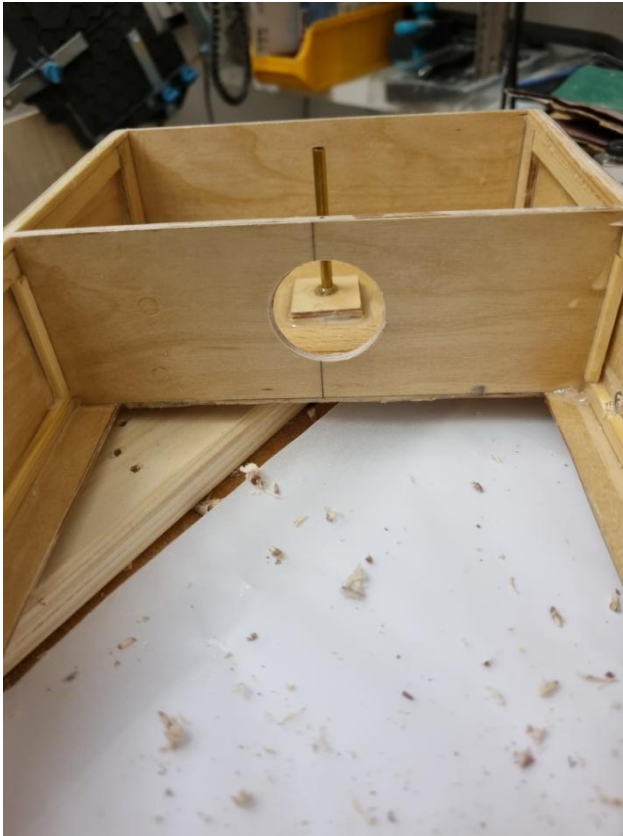
Foto 64: Kreisrunder Durchbruch in Spant 4, analog auch in Spant 7
