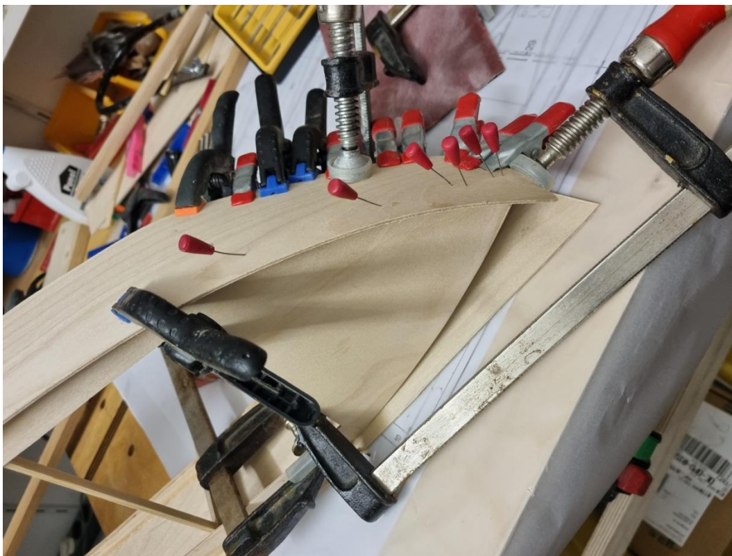
Foto 40: Die Verleimung im ganz vorderen Bugbereich gleicht der „widerspenstigen Zähmung“. Man kann das Sperrholz ein wenig mit Wasser befeuchten, um es geschmeidiger zu machen. Hier muss das Ganze über Nacht trocknen, bevor die andere Seite dran kommt.
