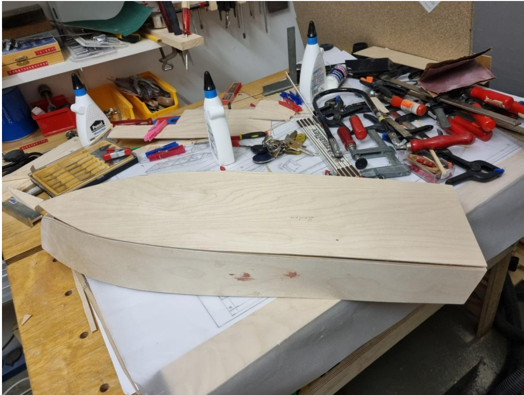
Foto 47: Der Rumpfboden kann nun eingepasst werden
