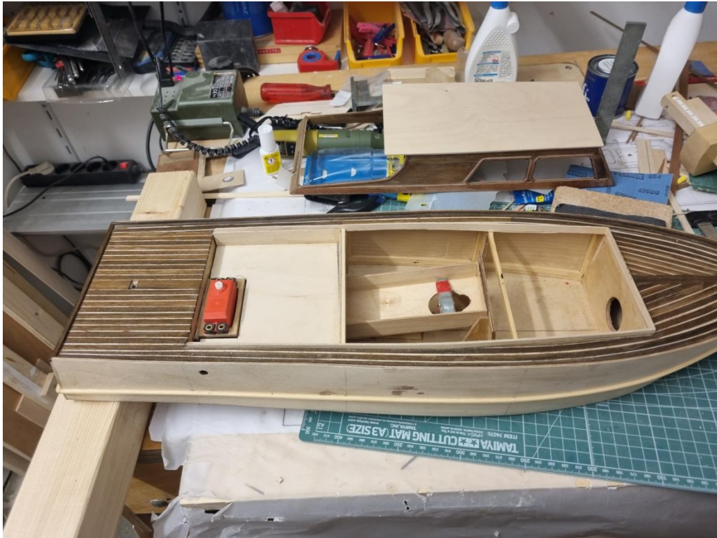
Foto 66: Die Akkurutsche wird gemäß Bauplan im Rumpf platziert, aber nicht verklebt, sondern sie bleibt herausnehmbar!
