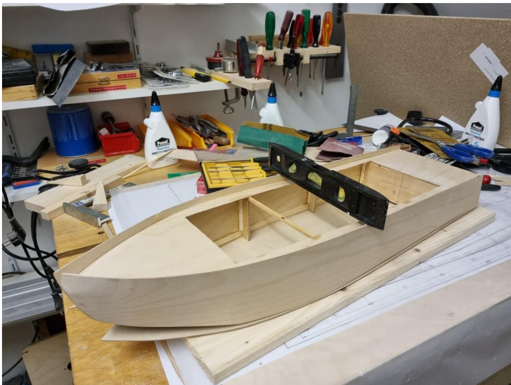
Foto 53: Vor dem Weiterbau wird der Rumpf auf evtl. Verzug überprüft
