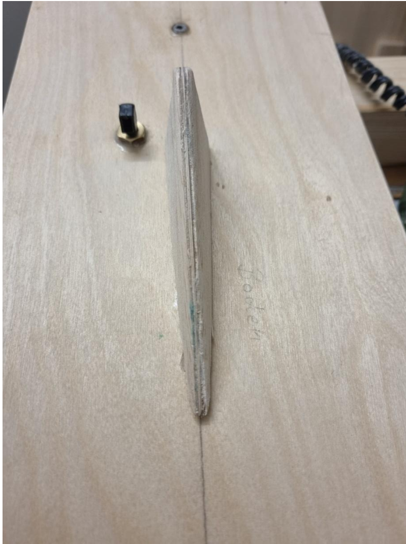
Foto 71: Die Wellenhose, jetzt mit Balsaholz beplankt und am Rumpfboden in Position geklebt
