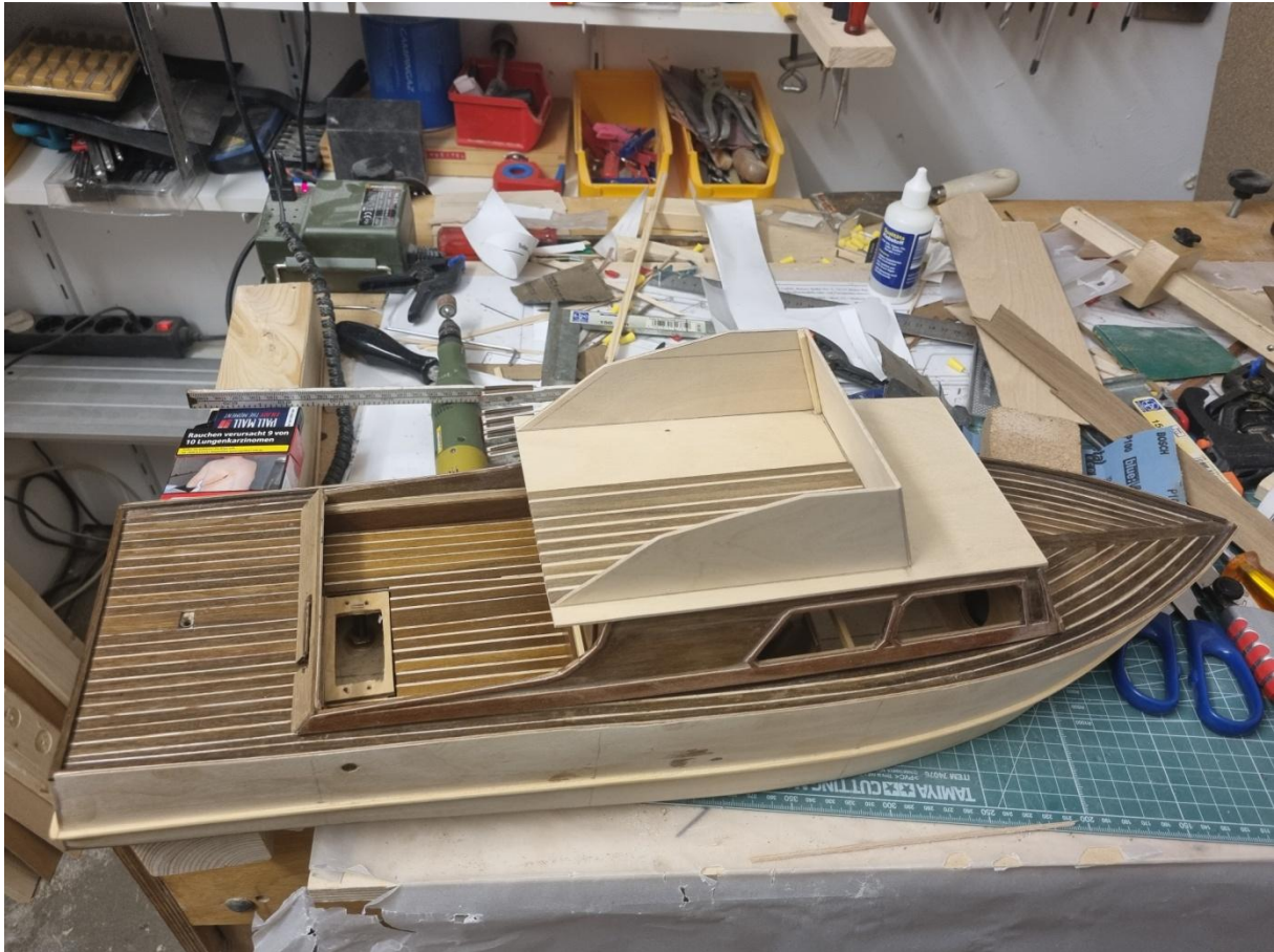
Foto 99: Das Fahrdeck wird nun ebenfalls mit Nussbaumplanken belegt
