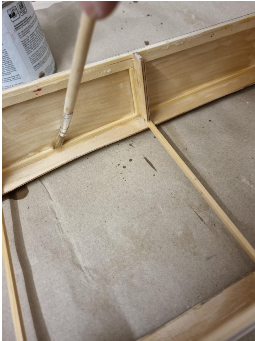
Foto 49: Mindestens 2 Anstriche sind nötig. Ich habe das Ganze vorsorglich anschließend noch mit einem dritten Anstrich mit Klarlack versehen. Da sollte jetzt kein Wasser mehr eindringen!
