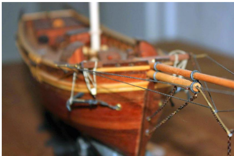
Klüverbaum, Bugsprit mit Takelage, auch die Anker sind schon montiert
