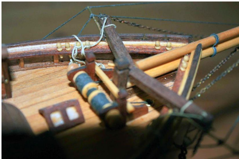
Davids, Klüverbaum mit Bugspriet, Ankerwinde (Alle Modellfotos: Der Verfasser)
