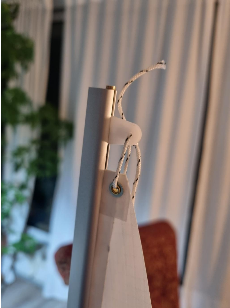
Hier sehen wir den Topbeschlag am Mast für das Großsegel
