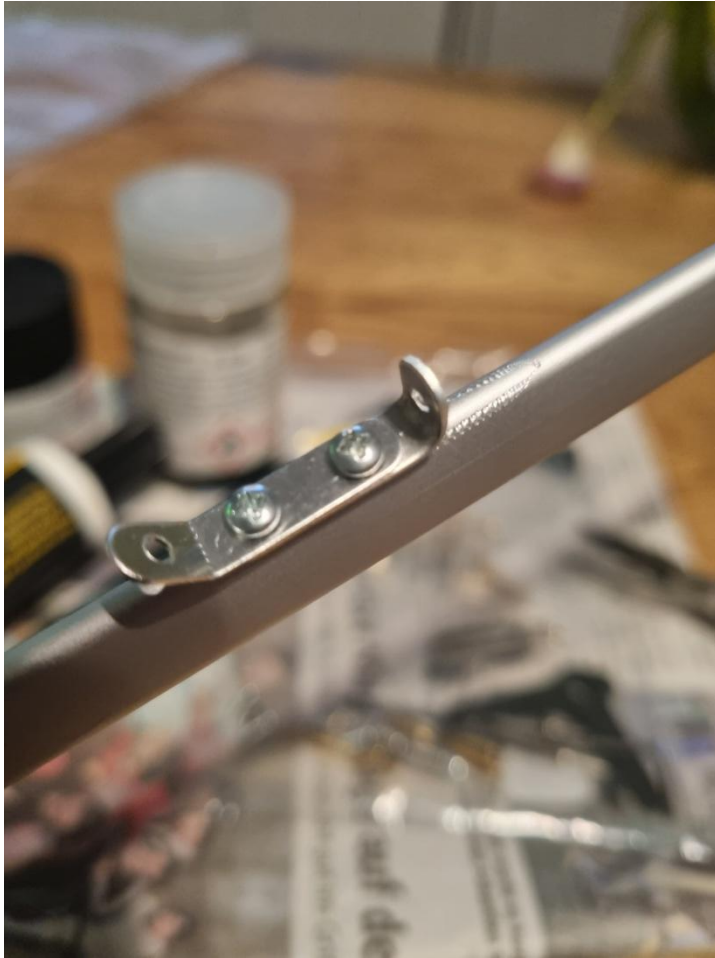
Lampenkonsole und Aufhänger für die Warten
