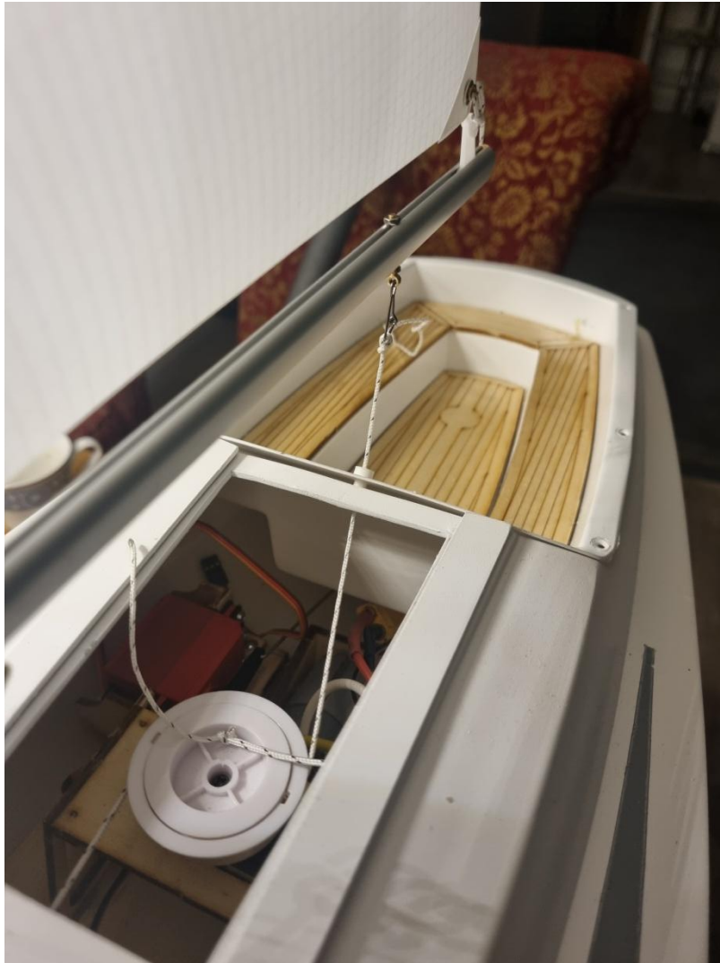
Finde den Fehler: Schotdurchführungen nicht korrekt!
