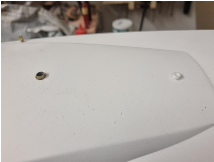
Verkleben des Mastfusses (links) und der Schotdurchführung für die Fockschot (rechts)
