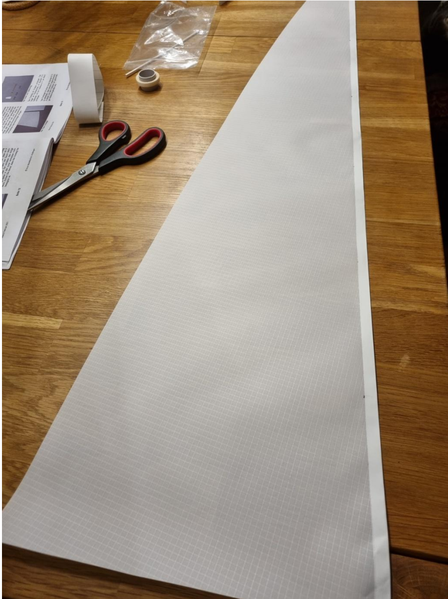
Das fertig verklebte Verstärkungsband am Vorliek des Segels
