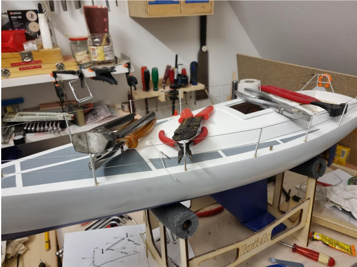
Die Reling auf der Backbordseite wird fertiggestellt. Die Relingstützen werden beim Verkleben beschwert und in Position gedrückt.
