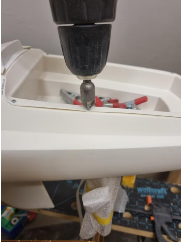
Die bessere Methode: Ansenken mit einem Senker
