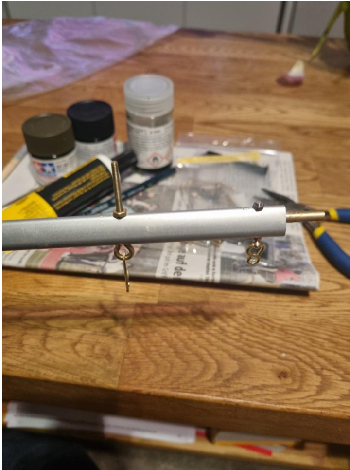
Befestigung Lümmelbeschlag und Niederholer. Die Muttern möglichst mit Sicherungslack sichern!
