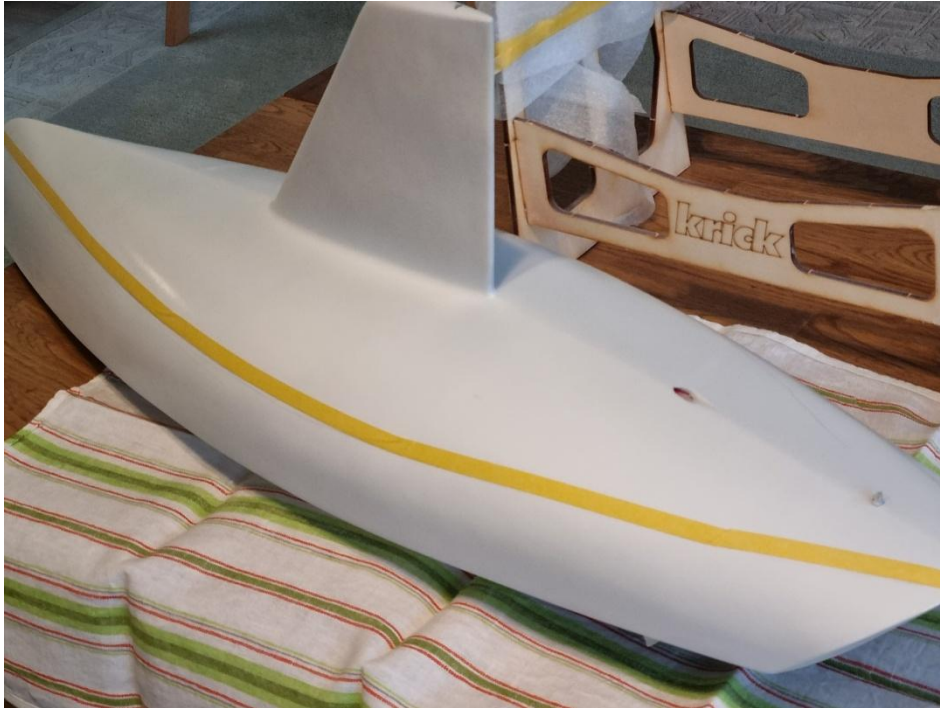
Der 1. Versuch mit normalem Maskierband fiel nicht befriedigend aus, weil dieses Klebeband wenig für kurvige Verläufe geeignet ist
