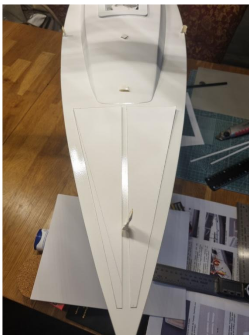
Die Schablonen für das Vordeck entstehen
