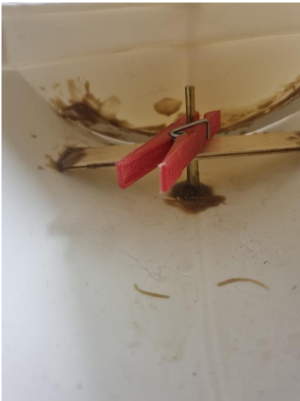
Hintere Rumpfverstärkung und Ruderlager mit Ruderabstützung
