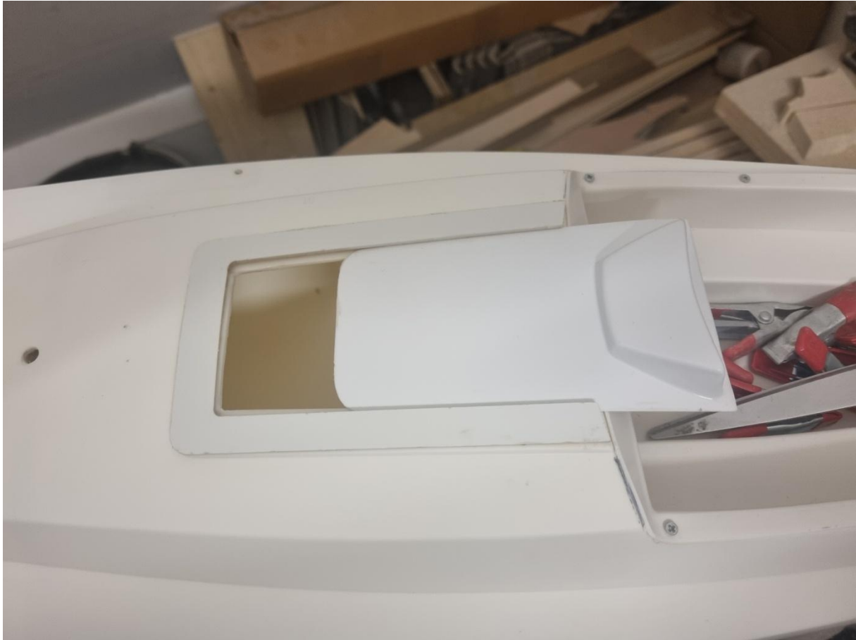
Das Schiebeluk wird von hinten unter den Rahmen geschoben und durch diesen gehalten
