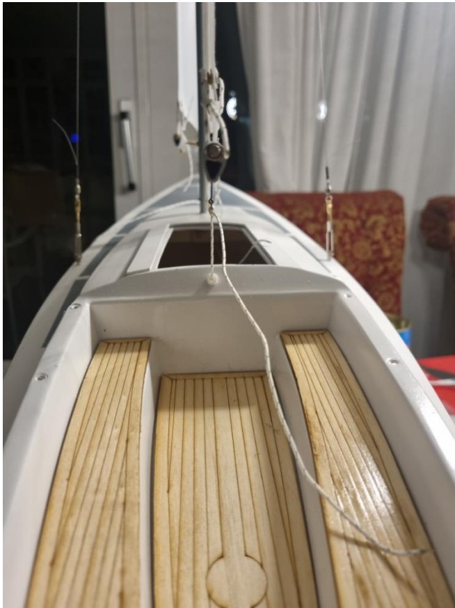
Hier die Schotdurchführung für den Großbaum!
