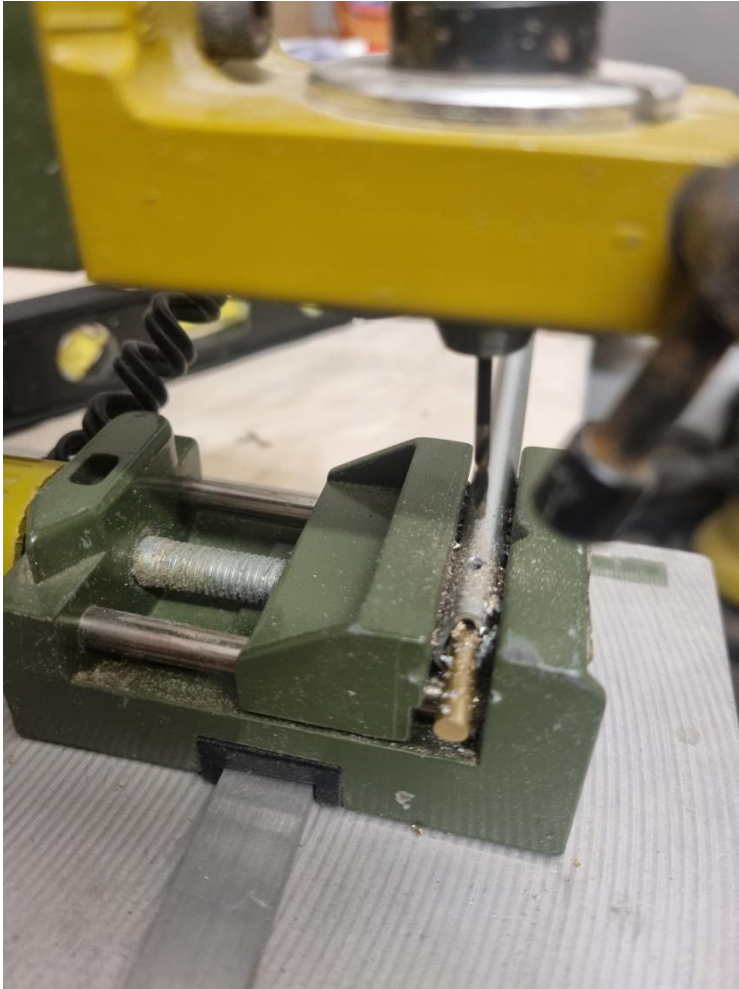
Loch bohren (hier mit 2 mm Durchmesser). Nicht zu viel Druck Auf den Bohrer geben und mittlere Drehzahl verwenden.
