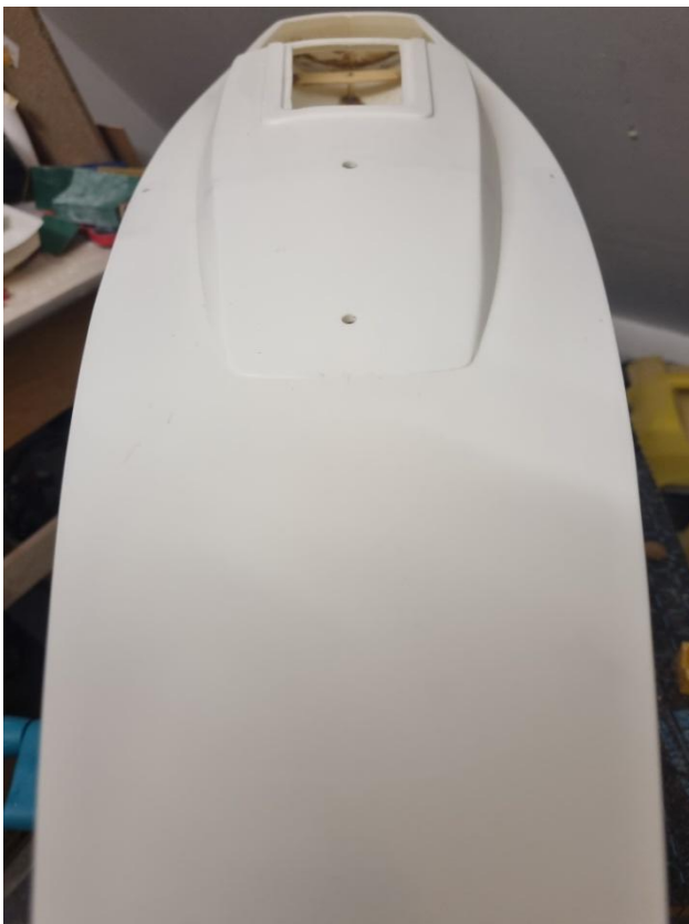
Das Foto zeigt die Bohrungen im Deck für das Mastlager (hinten) und für die Schotdurchführung (vorn)
